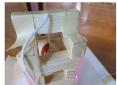
Tour renforcée à l'aide de pailles avec un pendule à l'intérieur.
