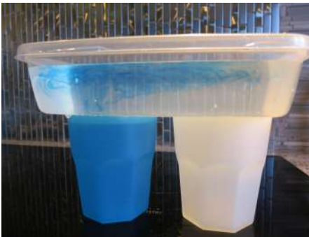
Récipient d'eau pose sur deux gobelets. Le gobelet bleu contient de l'eau chaude. Remarquez ce qu'il se passe : le colorant alimentaire qui a été ajouté au-dessus du gobelet d'eau chaude se répand.
