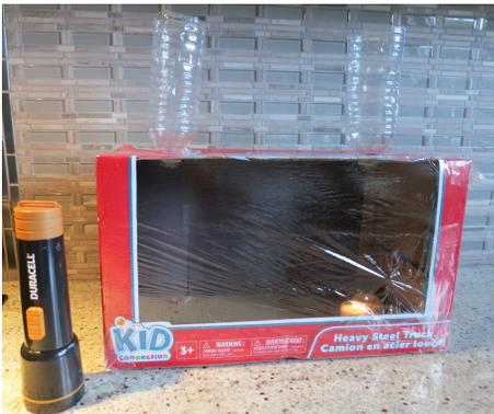
Boîte à convection, avec bougie allumée sur la droite. Une torche peut être utilisée pour mieux voir la fumée à l'intérieur. Notez que vous devez vous assurer de rendre hermétiques TOUTES les ouvertures (trous et fissures) autres que celles créées sur la partie supérieure pour les deux bouteilles. Orienter la torche à un angle idéal pour illuminer la fumée sortant de la « cheminée » s'avère tout particulièrement utile.
