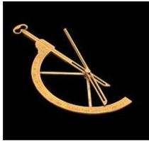
Un goniomètre est un instrument qui permet de mesurer un angle ou permet de faire pivoter un objet à une position angulaire précise. Le terme « goniométrie » provient des mots grecs pour l'angle et la mesure. La première utilisation connue d'un goniomètre a été par Gemma Frisius en 1538.
