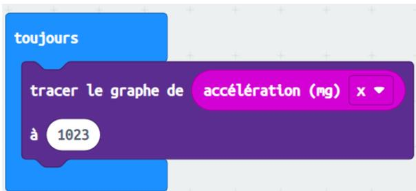
Pour obtenir un tracé de l'accélération et mieux comprendre la direction surveillée, les étudiants devront brancher le micro:bit à l'ordinateur, et lorsqu'il est en cours d'exécution, cliquez sur le bouton de l'option « Afficher le périphérique de données » (et non le bouton « Afficher le simulateur de données »).
