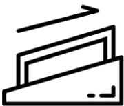
Vis – Une vis est un plan incliné autour d'un cylindre. Il convertit le mouvement cyclique en mouvement directionnel, en utilisant le plan incliné pour réduire la quantité de force nécessaire pour le perçage.
